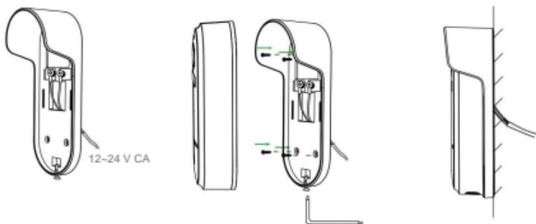
1. Preparare gli accessori necessari per l'alimentazione CA 2. Collegare la staffa con l'alimentazione CA 3. Installare la telecamera nella staffa e bloccarlo con la vite
