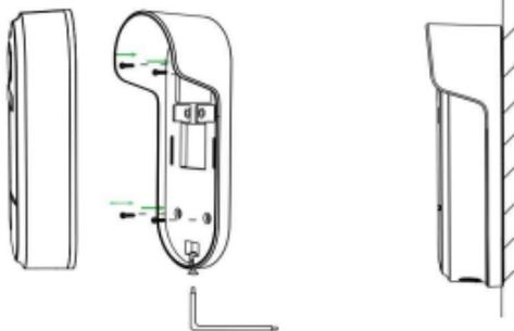
1. Fissare la staffa al muro con le viti di montaggio 2. Installare la telecamera nella staffa e bloccarla con la vite
